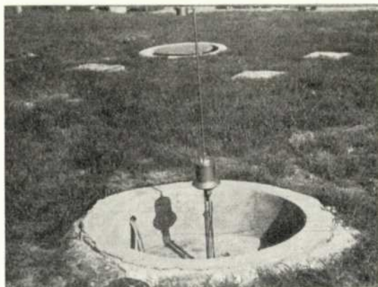
11. ábra: Lélegektromos potenciálmérő szonda és vertikális árammérő lemez
