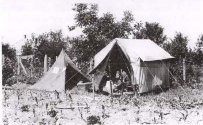
18. Magnetotellurikus mérési pont. A műszerek a jobbra lévő sátorban vannak, elől látható a variométer tápegysége, mögötte Wallner Ákos figyelő a regisztráló műszert (ez a régi T9-es, kiegészítve két csatornával a mágneses komponensek számára).
