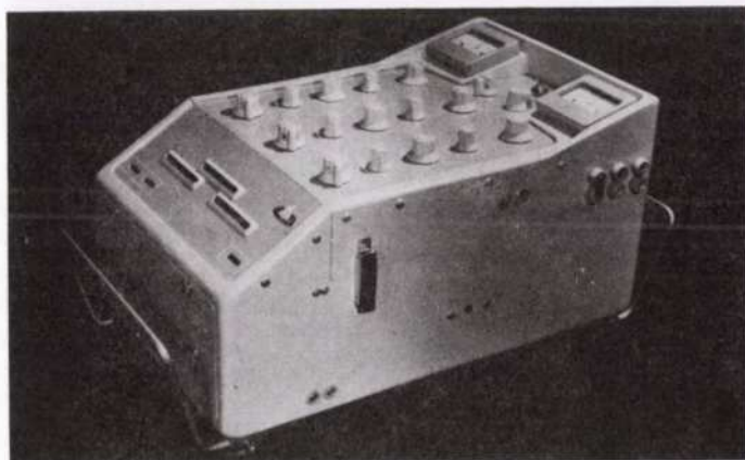
19. A "totális számláló" műszer, az első lépés a tellurikus mérés automatizálása terén.
