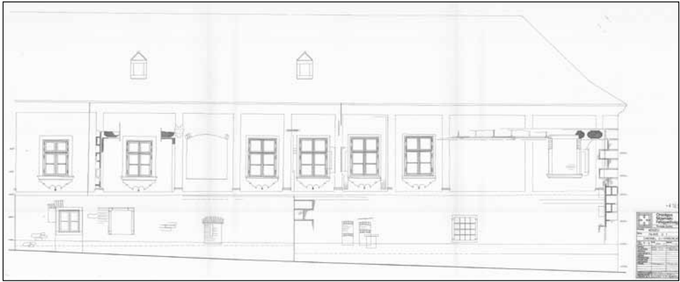
11. kép. A lakóház Chernel utcai homlokzatának felmérése a kutatás után. Rajz: Sedlmayr János, Oláh M. Zoltán 1982. MÉM MDK Tervtár, ltsz. R41059
